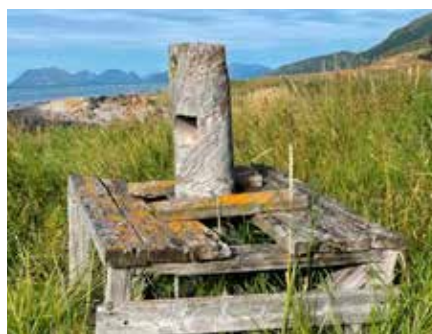
Tømmertransporten på Vansjø skjedde ved hjelp av gangspill, en mekanisk trommel til å hale tau med.
